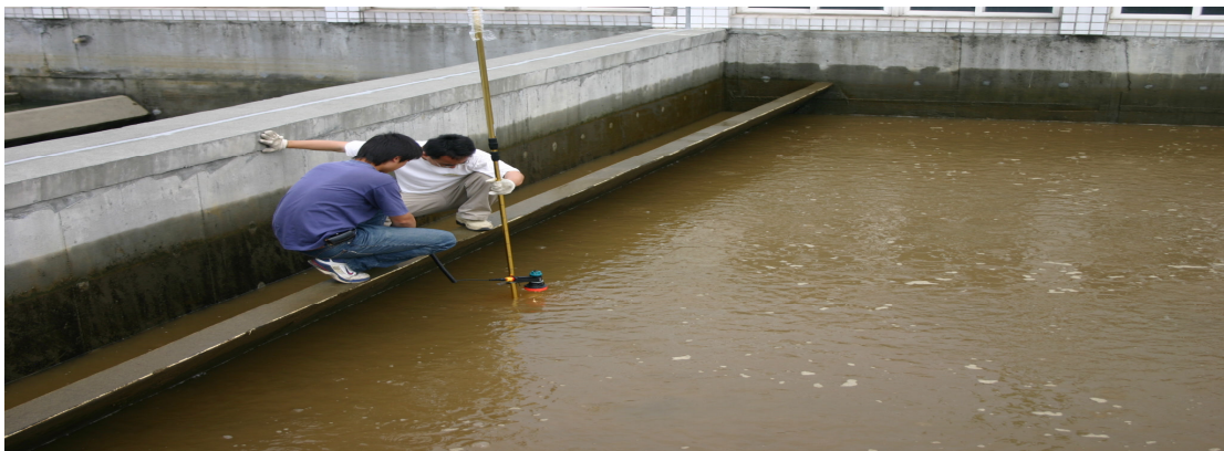
圖 9 以圓盤觀測濾料膨脹情形
