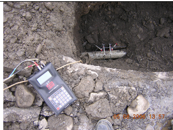
圖五 分段計量檢測工法：以攜帶型的管夾式超音波流量計，採分段開挖計量檢漏的測試點。
