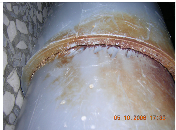
圖八：在高壓（約 4 \text{ kg/cm}^2 ）的長期漏水衝蝕下，呈凹陷的漏水管。
