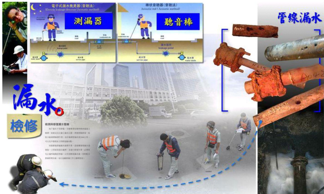
圖 4-32 臺北的主要漏水檢測方式為人工巡迴聽音 [資料 2]
