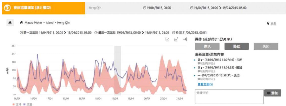
圖 4-49 以 Aquadvanced 系統進行智能推論並疊合實際流量 [資料 3]
