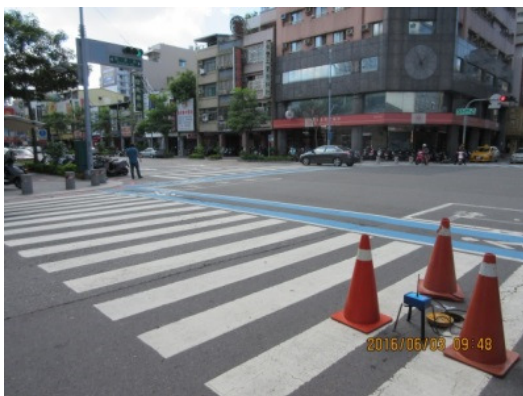
(g) 噪音記錄器判讀漏水處，管段兩端裝設感測器 A
