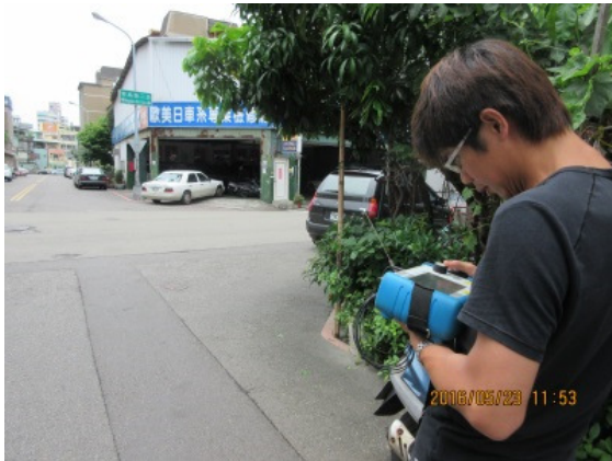
(h) 車巡訊號品質不佳，人工移動式無線下載
