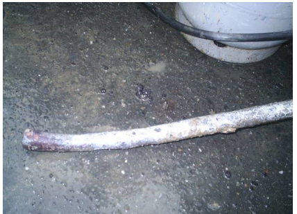
9. A 漏水點-2 巷 23 號， \phi 20 接合管管套節鉛管焊接點穿孔漏水
