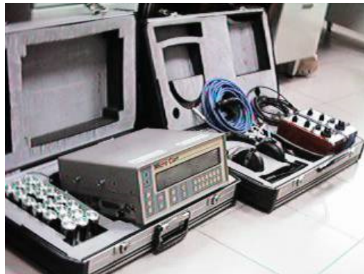
(a)相關式漏水探知器(1988)
