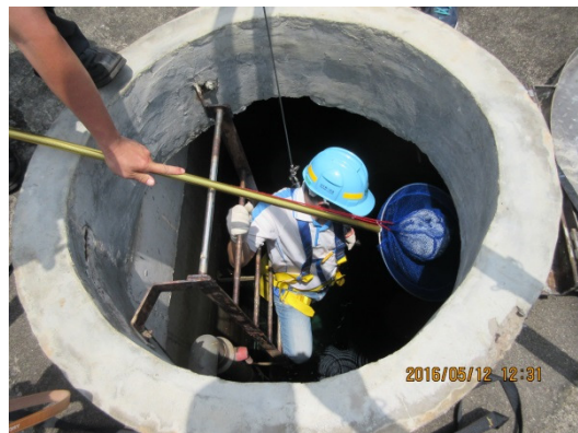
圖 30、南化淨水場清水池投入感測球
