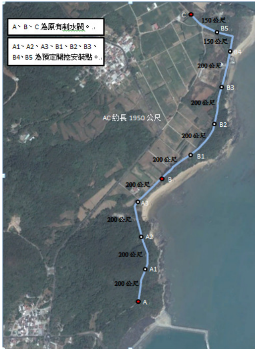
(a)每 200 公尺共設 11 處測漏探頭
