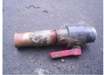
10. B 漏水點-3 巷 12 號， \phi 50 塑膠管考克接頭漏水
