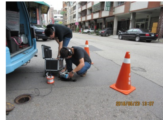
(j) 噪音記錄器判讀漏水處，管段兩端裝設感測器
