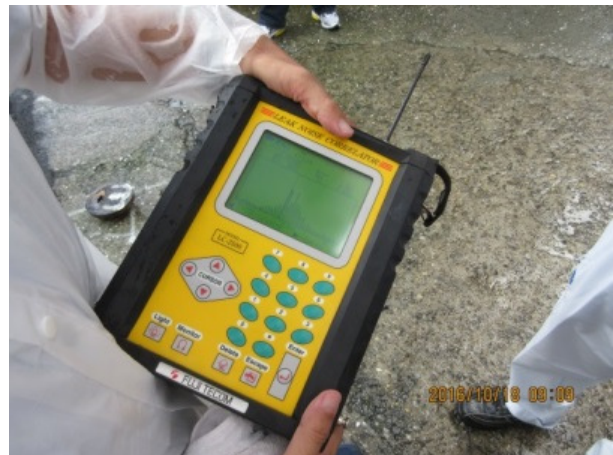
(d) 相關儀複測 CH 管段，測出 113 巷 12 號另一漏水點。
