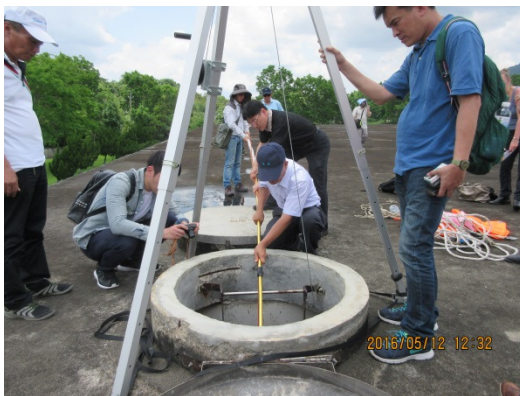
圖 30、南化淨水場清水池投入感測球
