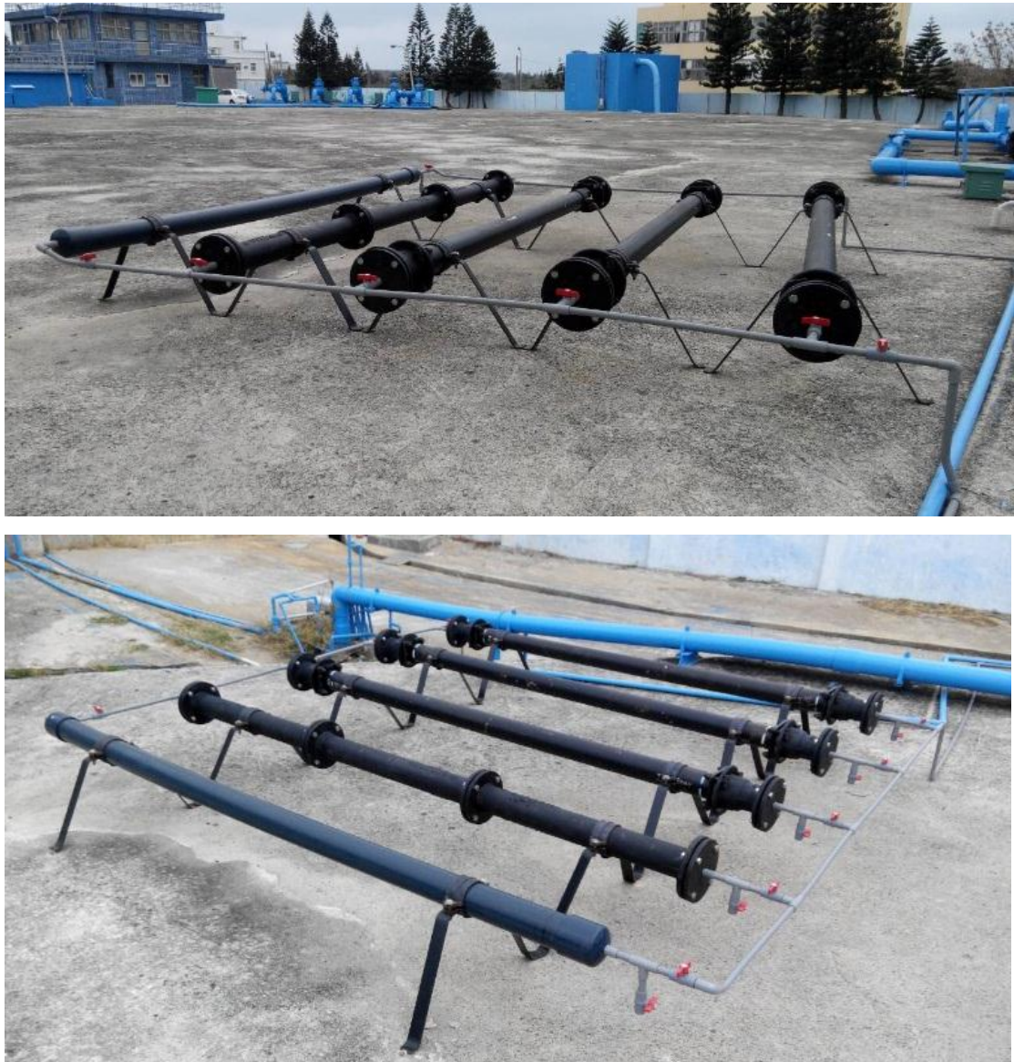
圖 4-1 鹽井淡化水試驗組現場佈置圖（成功淨水場）
