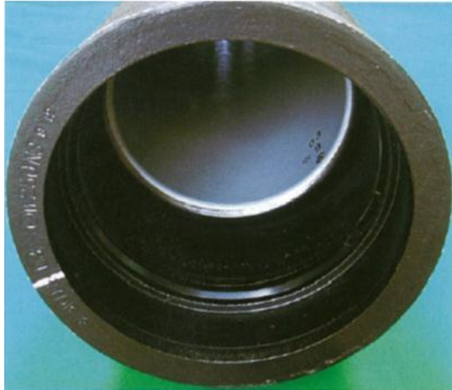
圖 2-4 環氧樹脂粉體塗裝 DIP (東京水道局提供)
