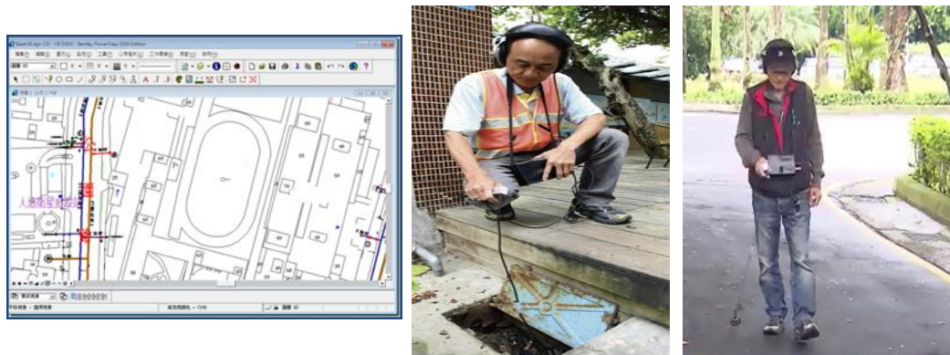
圖 6-1 閱圖資並利用儀器檢測內線漏水點
