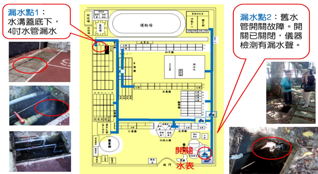
圖 6-6 機關學校節水輔導案例-協助學校測漏找出漏水點
