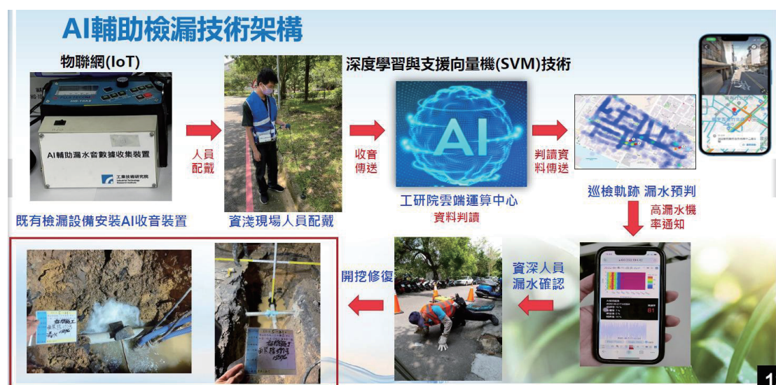
圖 2.2- 2 AI 輔助檢漏技術架構
