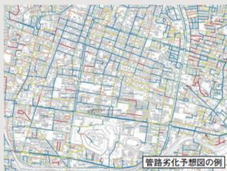
圖 2.2-7 日本會津若松市上下水道局 AI 診斷管線劣化度可視化
