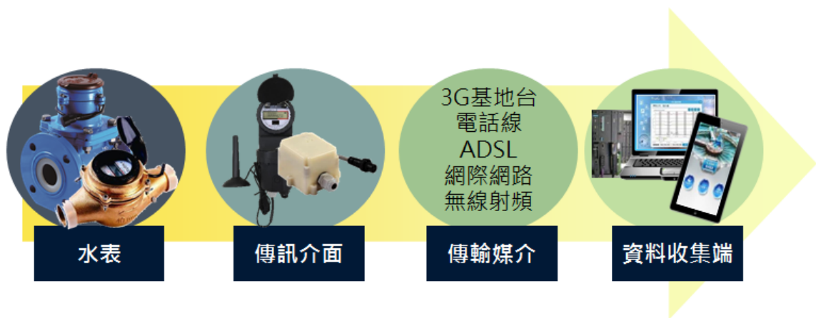
圖 33 A 廠商之 AMR 系統示意圖
