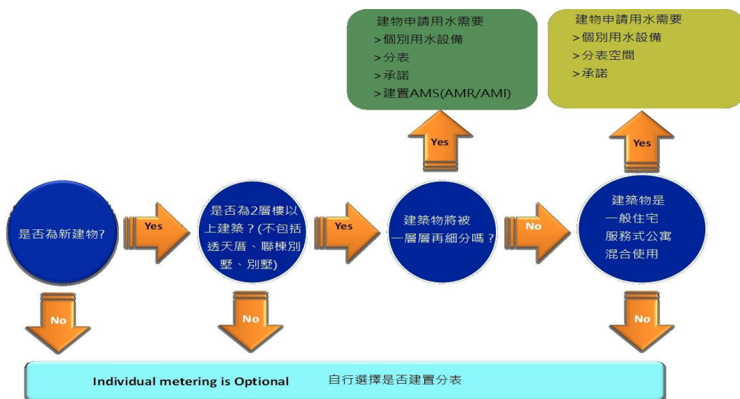
圖 19 雪梨水務公司將 AMS 納入多層建築物使用水表判斷準則
