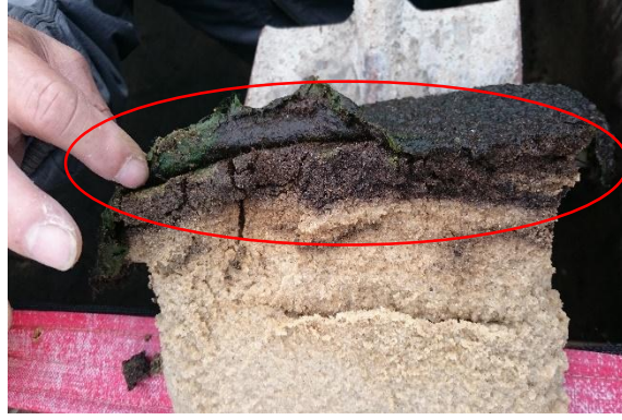
圖 4.4-49 吉貝場慢濾池老舊生物膜(完整生態系)
