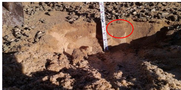
圖 4.1-47 未前加聚氯化鋁之濾砂表層(生物膜在砂層表層 5 公分顏色較深)
