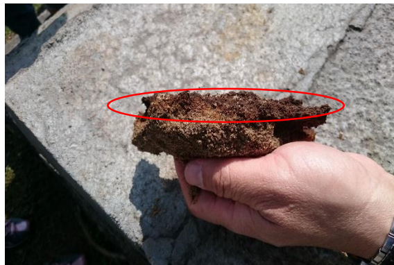
圖 4.4-27 西螺場刮砂後濾砂剖面圖
