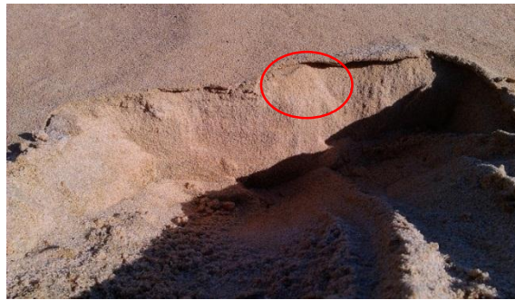
圖 4.1-46 加聚氯化鋁累積在濾砂表層(生物膜在表層不明顯)
