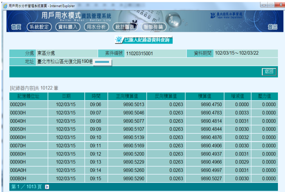
圖 4-12 用戶用水模式管理系統匯入之 AMR 傳輸資料畫面
