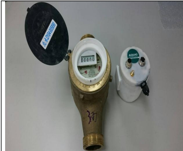
圖 5-29 乙廠商 無線讀表裝置底座 固定
