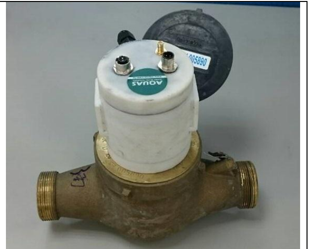
圖 5-30 乙廠商 無線讀表裝置組裝 完成
