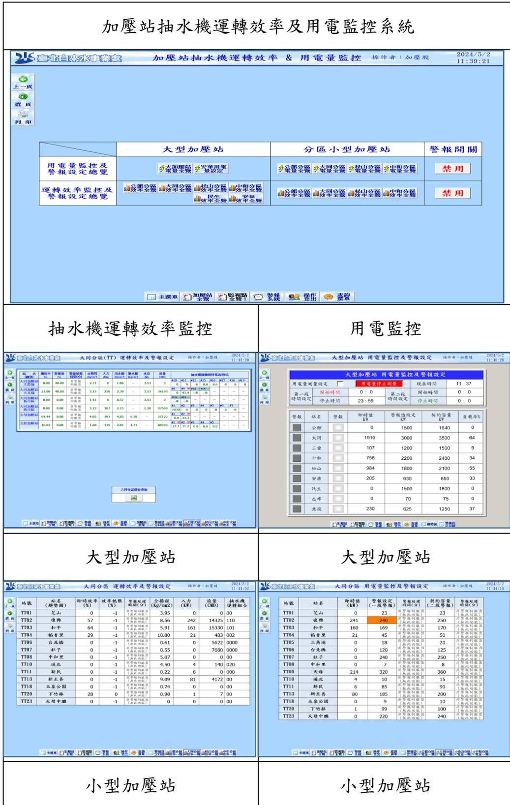
圖 4-20 北水處加壓站抽水機運轉效率及用電監控系統
