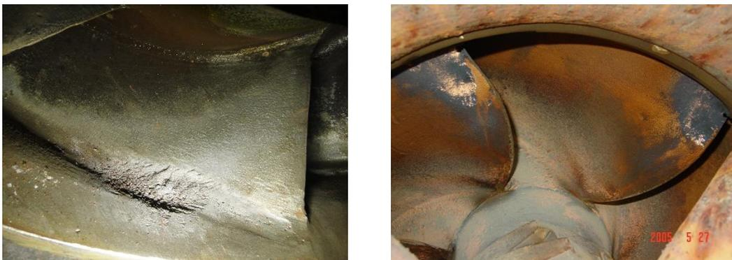
圖 3-2 泵浦葉輪孔蝕現象
