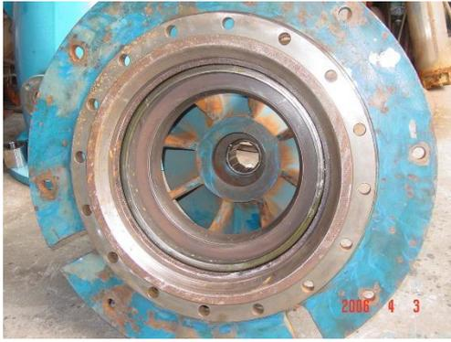
徑向軸承摩耗(橡膠)
