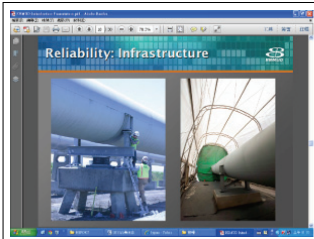
圖 5.2.1-12 水管導水路基礎隔震
