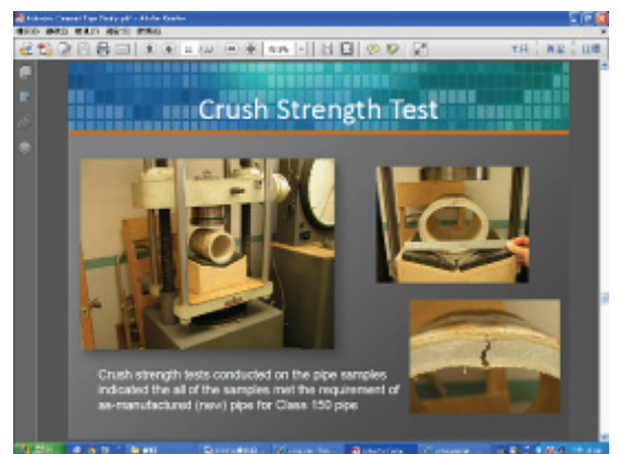
圖 5.5.2-8 石棉管力學試驗
