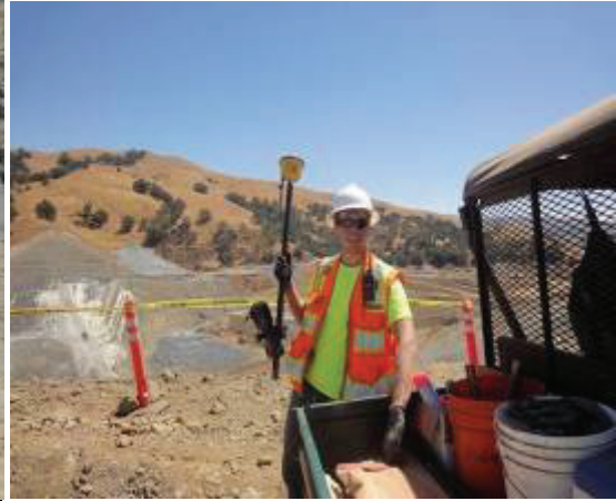
圖 4.3-11 利用 GPS 量測位移
