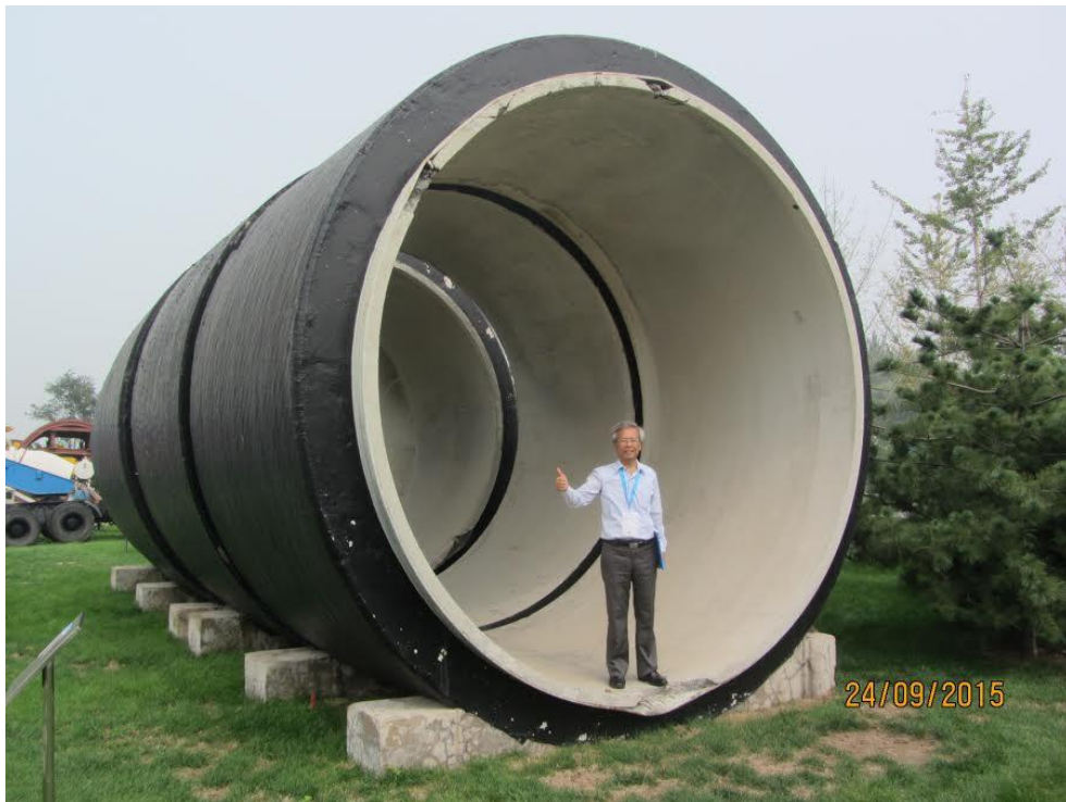
圖二十：南水北調使用 4M 預力鋼襯混凝土管(PCCP)
