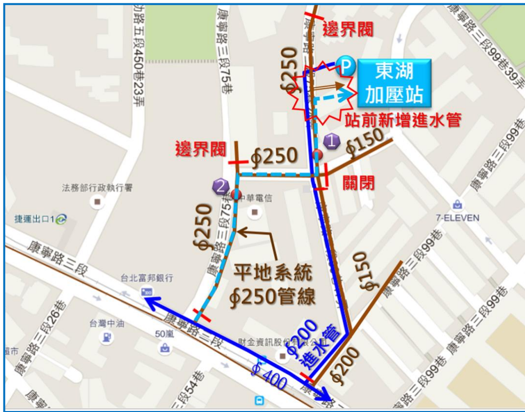
圖 119 東湖加壓站新增進水管
