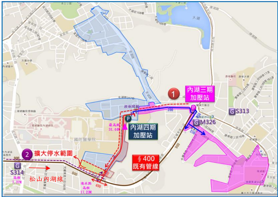
圖 132 內湖四期加壓站洗管作業
