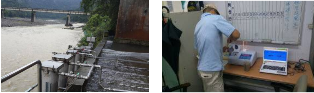
圖 3-2 翡翠水庫一號橋濁度偵測點(左) 現場人員實測(右)
