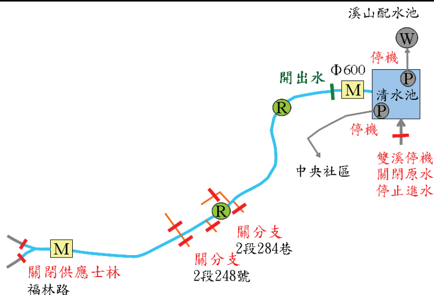
圖 4 Φ700mm 輸水管漏水測試示意圖
