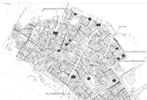
圖 13 主動檢漏成果(13 處漏水點)
