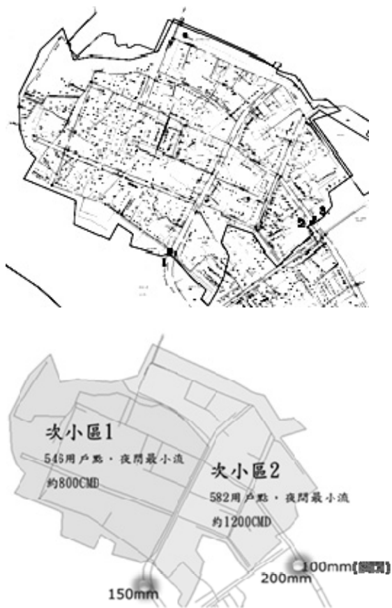
圖 4 旗津示範小區之次小區法檢漏作業
