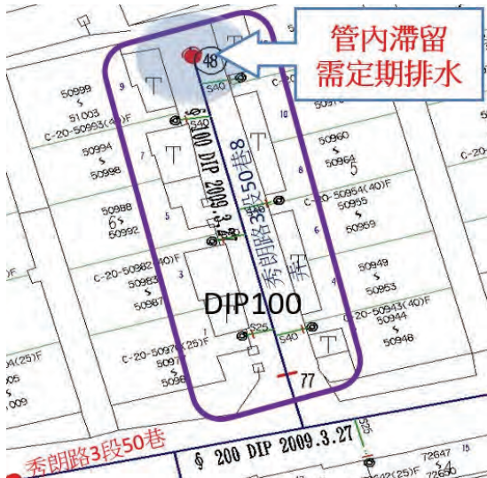
圖 2 管末端滯留水示意圖
