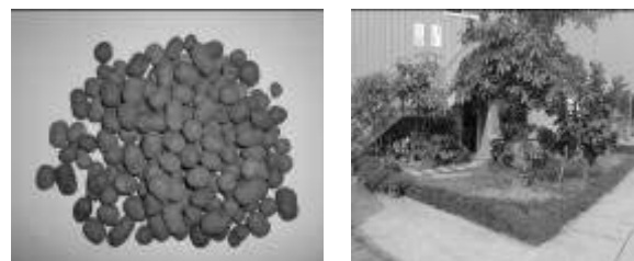
淨水污泥燒結人造 輕質骨材成品
