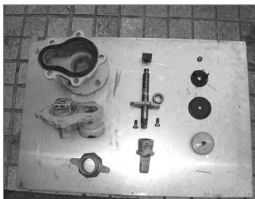
圖 1 地下式救火栓分解照片
