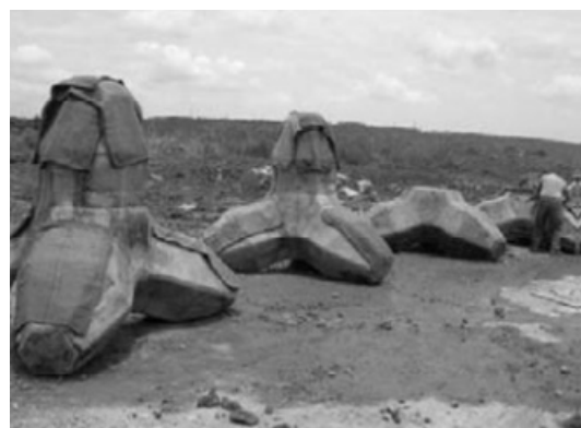
圖 2 水庫淤泥混凝土消波塊 [22]
