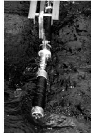
圖 2 浸入式光譜探棒組成的圖示 (左)。浸入式安裝的實例 (右)
