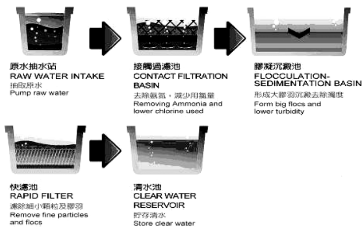
圖 2 鳳山淨水場工業處理系統流程
