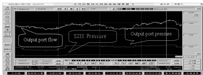
使用變頻器之加壓系統（壓力平緩）
