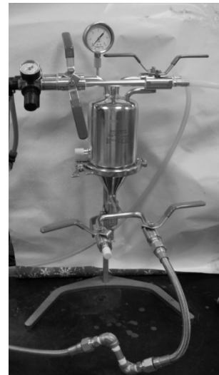
圖 5 反沖洗水 MF 回收設備照片
