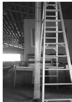
圖 7 以透明塑膠管量測水頭高度
