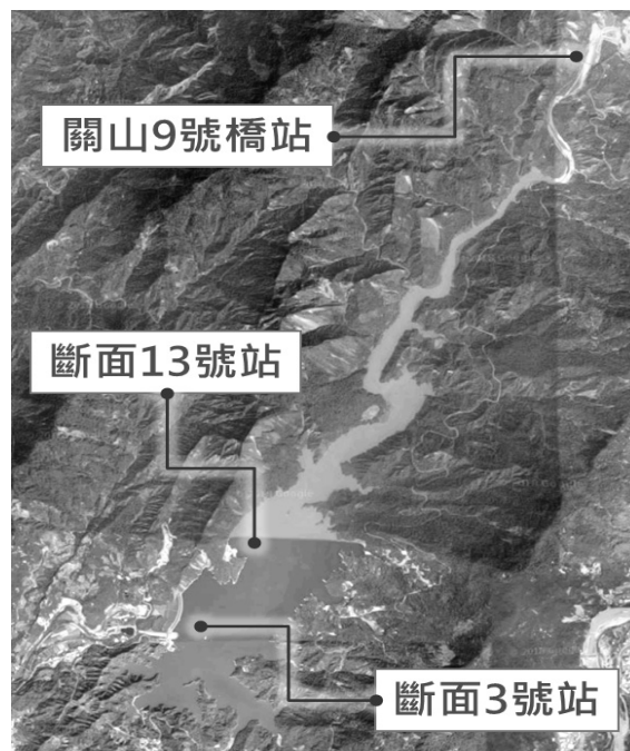
圖 4 南化水庫自動化泥砂濃度監測系統現況配置
