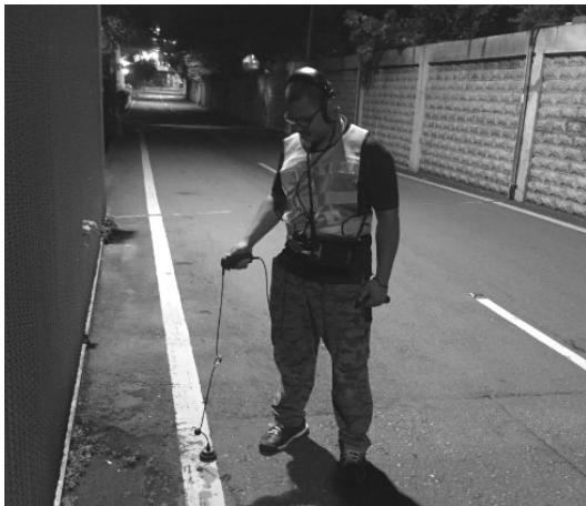
圖 1 夜間委外檢測漏作業照片
