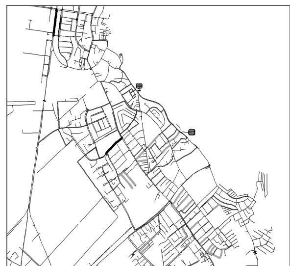
圖 7 中興地區反流次數多的管線（粗線部分）
