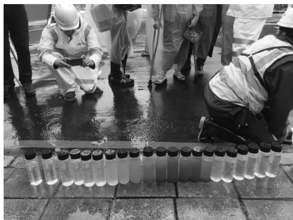
圖 18 碎冰排出各階段取樣
