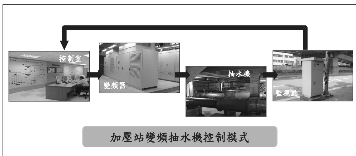
圖 7 變頻器遠端控制示意圖
