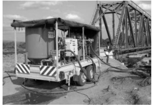
圖 13 移動性緊急供水系統運轉
