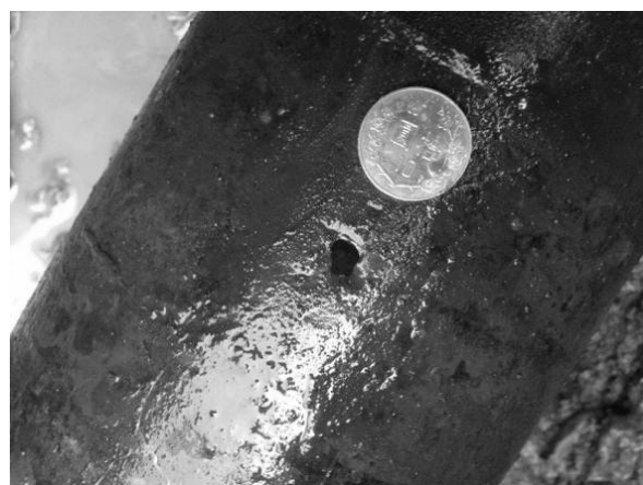
圖 13 \phi 150\text{mmDIP} 揚水管圓形孔洞
