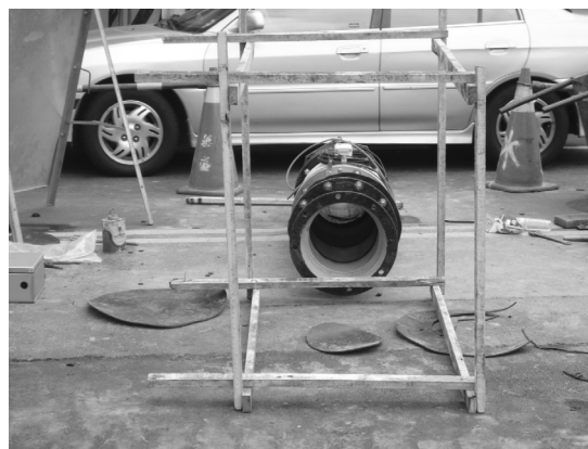
圖 4 口徑 300mm ABB 水表與 70cm 內寬框架並列照片示意圖
