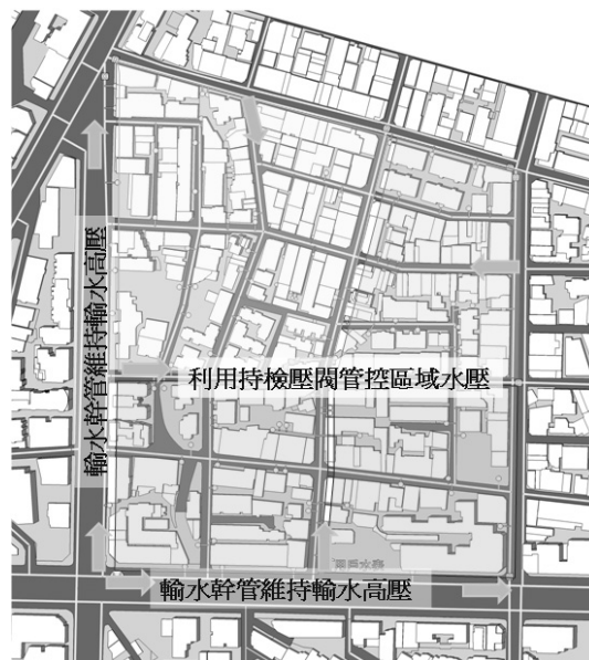
圖 17 設置持減壓閥均化各供水分區水壓
