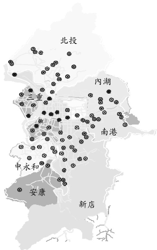
圖 8 北水處主要水壓監視點分佈圖
