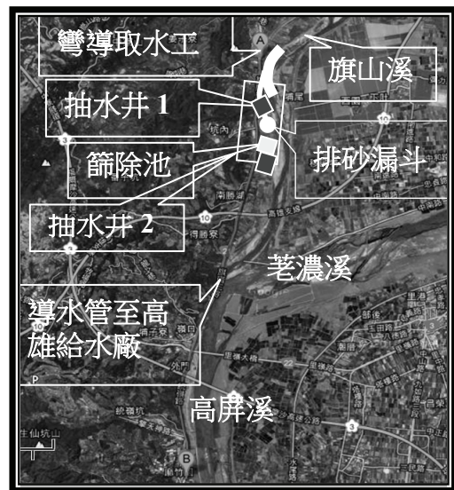
圖 9 彎道取水工等設施位置圖
