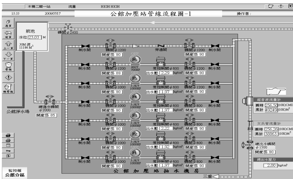
圖 2 公館加壓站管線流程圖
