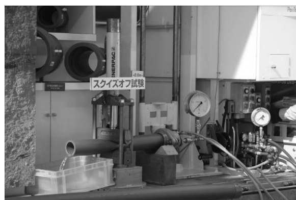
圖 12 PE 管耐壓試驗
