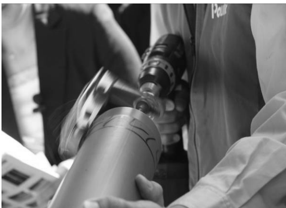
圖 16 刮管器刮平管線接管處
