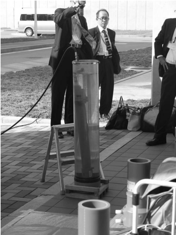
圖 14 管中注水加壓破壞實驗
