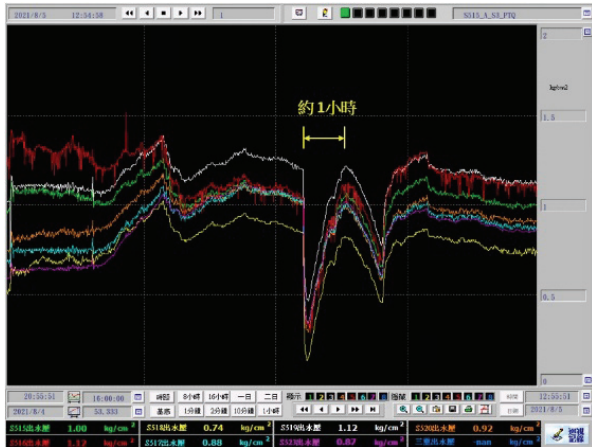
圖 2 震度 4 級以下監視點壓力趨勢變化
