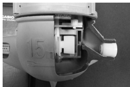
圖 14 水量計出口端按裝彈性式逆止閥
