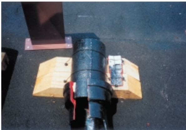
→ (圖8) 白口式鑄鐵管件 ↑ (圖7) 白口式接頭接合方式的剖面
