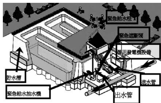
圖 2 鋼筋混凝土維生貯水槽示意圖 [5]
