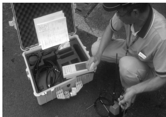
圖 7 漏水檢測相關儀
