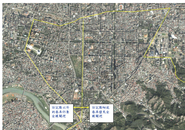
圖 17 虛線左側已都市化 60 年，殘留最多盲腸管，與佈點結果呈現一致性。
