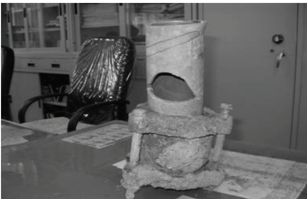
圖 15 裂縫漏水面積約 2.8\text{cm}^2
