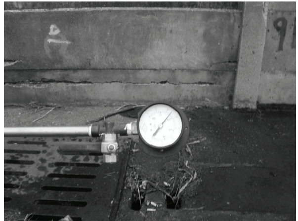
圖 16 修漏前檢測田尾水壓 1.8\text{kg}/\text{cm}^2
