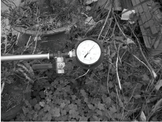
圖 19 修漏後滴仔水壓 1.8\text{kg}/\text{cm}^2
