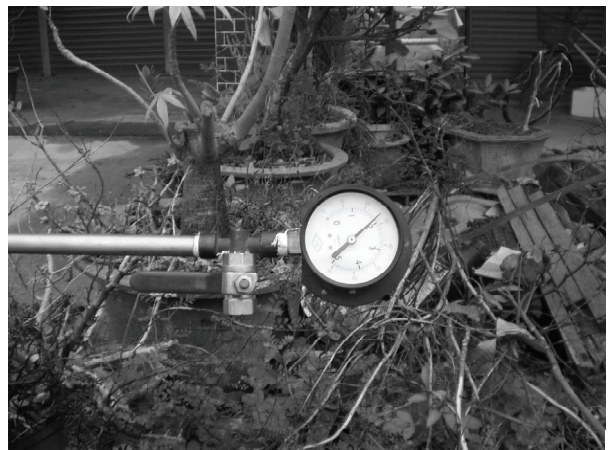
圖 17 修漏前滴仔水壓 1.7\text{kg}/\text{cm}^2
