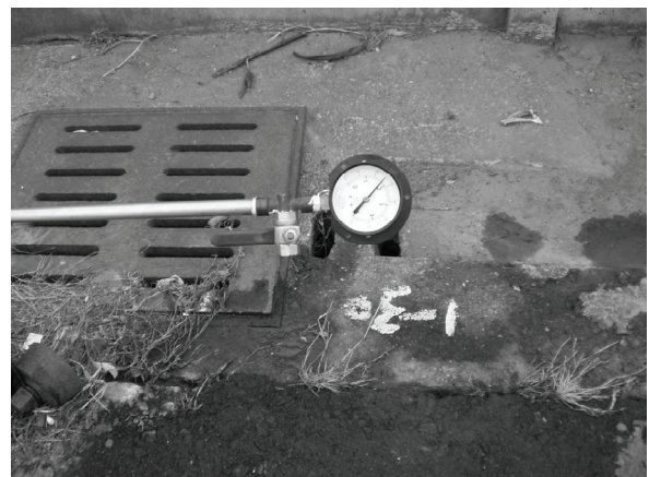
圖 18 修漏後檢測田尾水壓 1.9\text{kg}/\text{cm}^2
