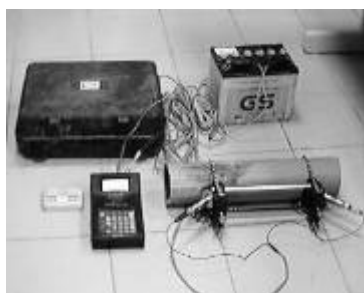
圖 1 攜帶超音波式水量計整套之計量設備（不需停水斷管；適用管徑 16mm~5000mm）
