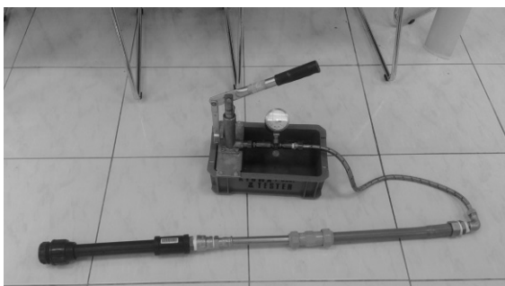
圖 8 HDPE 與不鏽鋼零組件接合試壓
