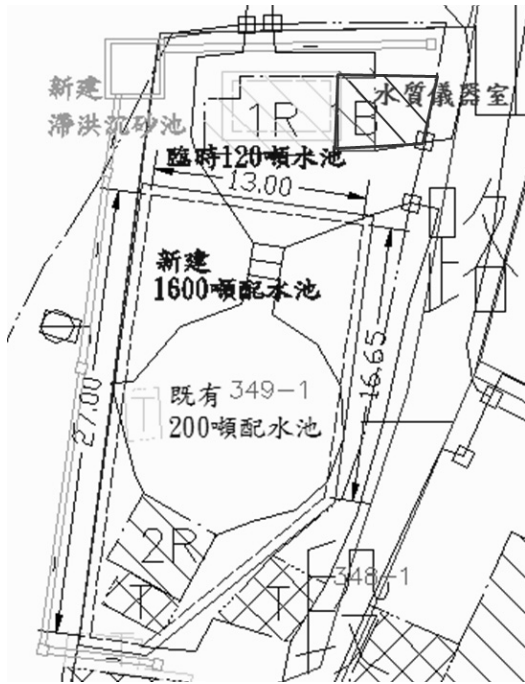
圖 13 中正加藥池改建方式示意圖
