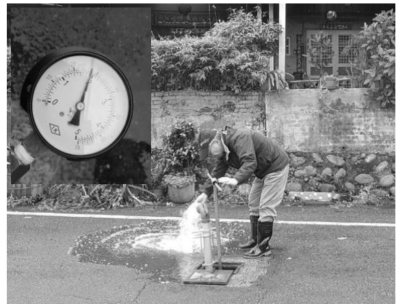
圖 9 現場量測壓力 2kg/cm 2 ，小於容許壓力 16kg/cm 2
