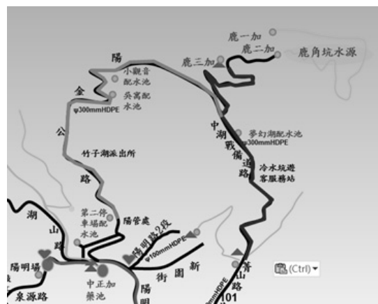
圖 6 鹿角坑水源沿線供水設備圖
