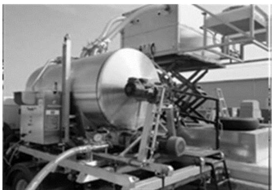
圖 6 發電機及加壓設備
