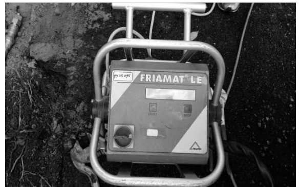
圖 13 提供熱源之 HDPE 熔接主機
