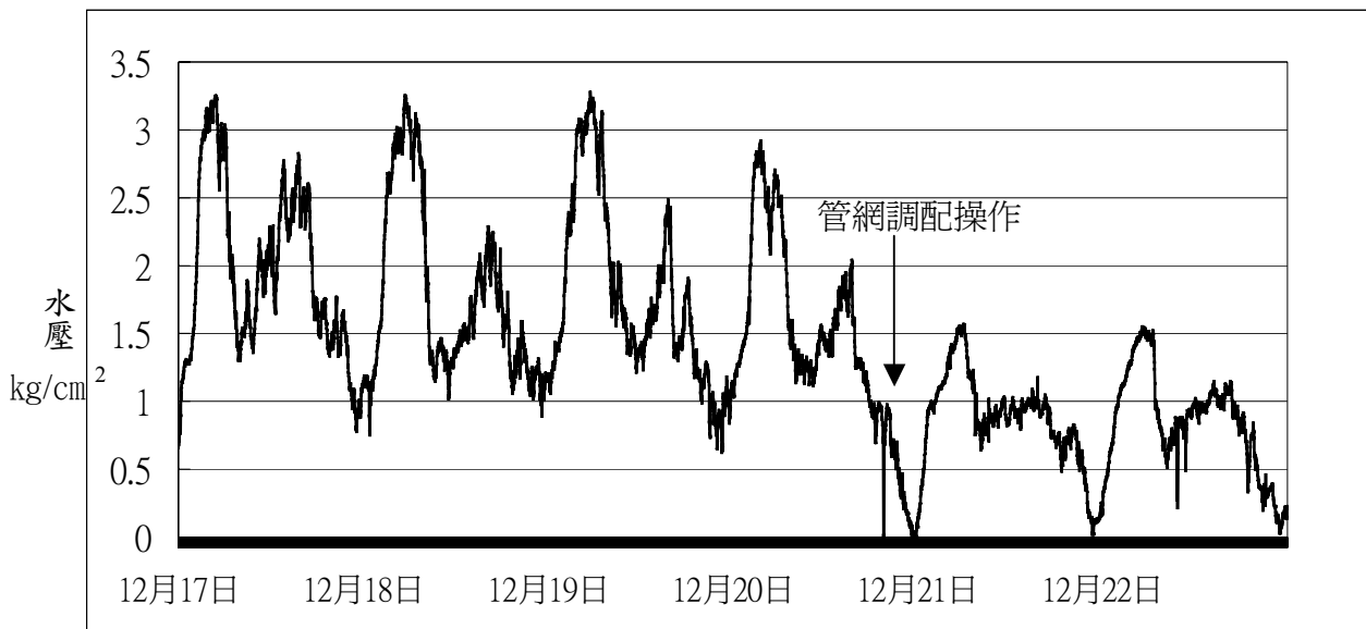
圖 10 馬達直接抽水用戶水壓連續監測趨勢圖
