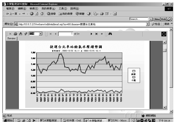
圖 8 水質偵測資料水壓餘氯變化趨勢圖
