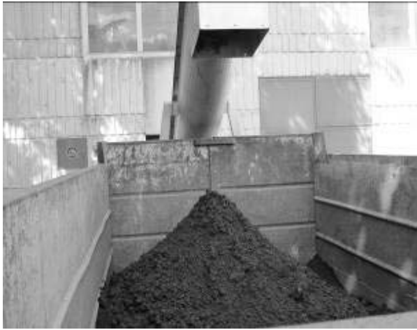
圖 20 離心式脫水機產生的污泥餅
