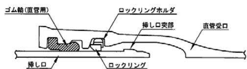
圖 7 GX 型接頭構造
