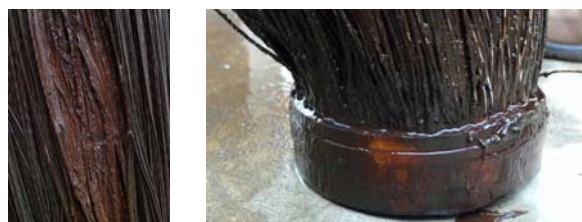
圖 9 中空絲纖維膜自壓力筒中取出的照片，可看出在膜間充滿了鐵錳污泥。
