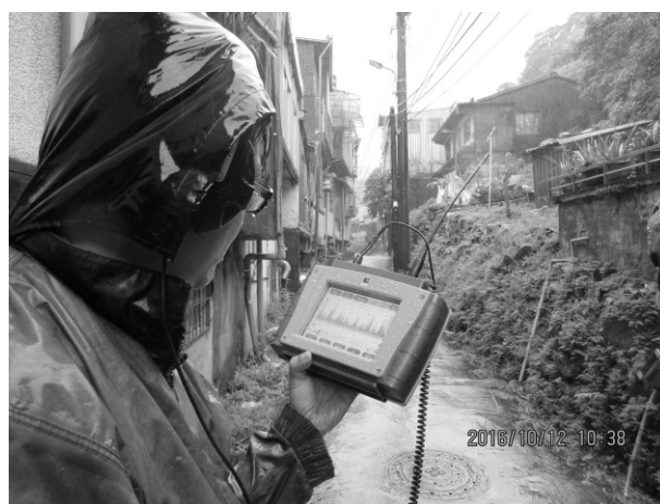
圖 4 可於雨中操作具 IP65 的漏水相關儀
