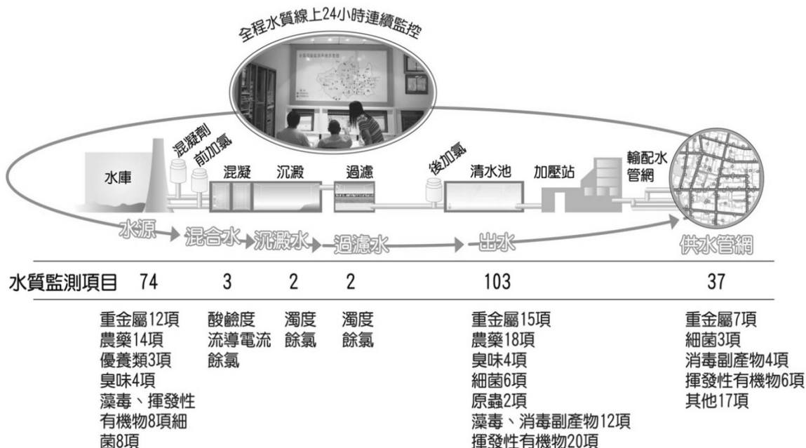
圖 7 北水處水質監測項目與即時監控
