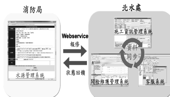
圖 7 北水處與消防局報修介接架構
