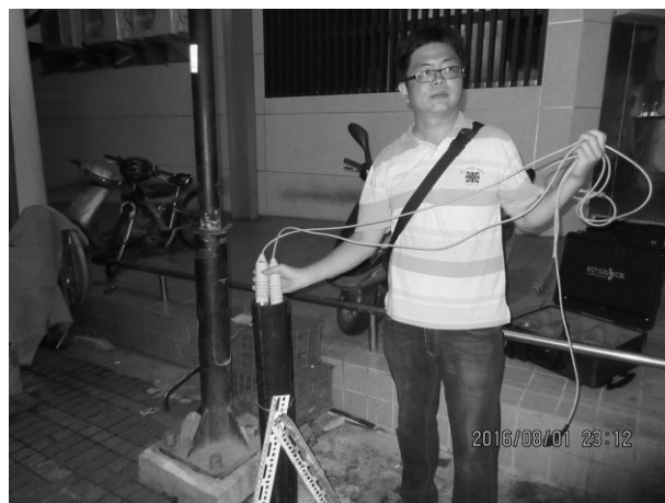
圖 8 捕音探頭浸水測試 IP 水密性
