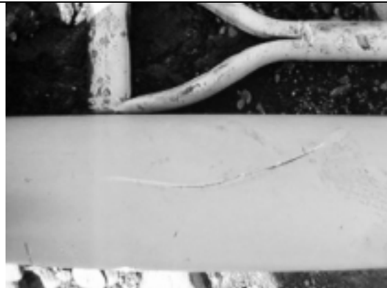
圖十五：100 mm PVC-PE 裂縫 14cm
