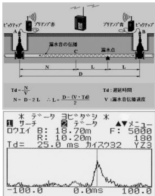
圖 4.相關式漏水探測法 (摘錄於日本富士地下情報公司)
