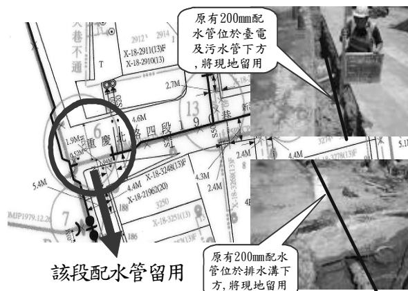
圖 4 舊有配水管無法汰換留用處理情形
