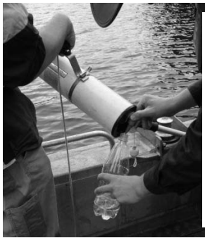
圖 3 採樣船上之聲納系統及採樣器
