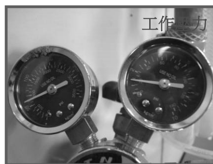
圖 10 調整工作壓力至 1\text{kg}/\text{cm}^2
