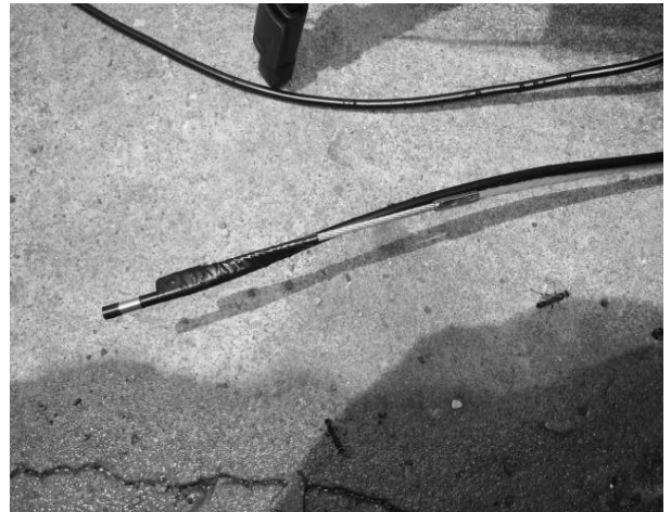
圖 1 長度 10 公尺的內視鏡軟管，以膠帶綁附硬導線。
