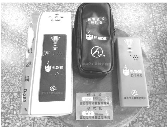
圖 5 俗稱「機器貓與頑皮鼠」，其具收、發信功能，可定位管線，惟應注意頑皮鼠進入管線內的水密性。
