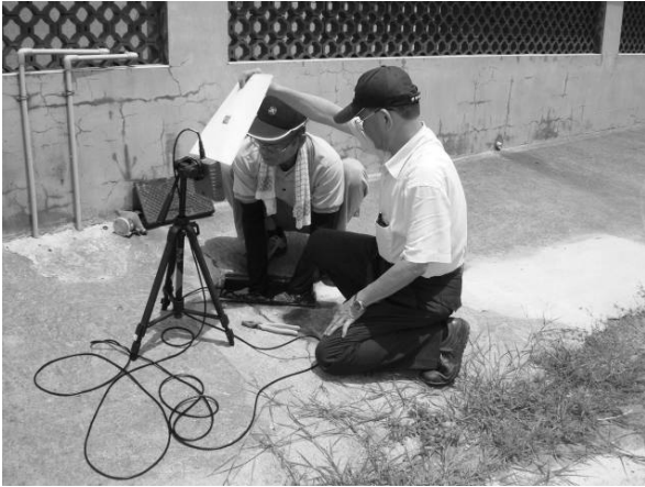
圖 3 檢視螢幕、找到丁字管或分歧點，並量測其長度距離。
