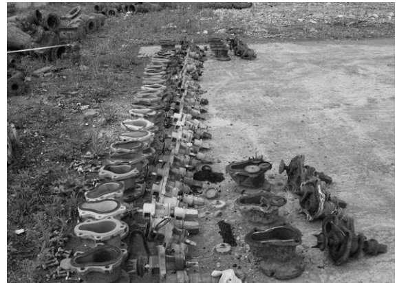
圖 4 地下式救火栓拆解 [1]
