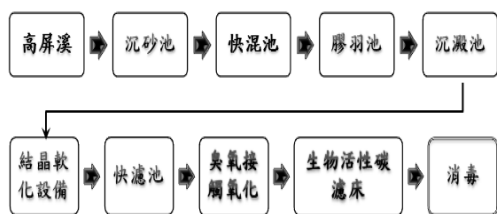
圖 5 鳳山場一期淨水設備處理流程
