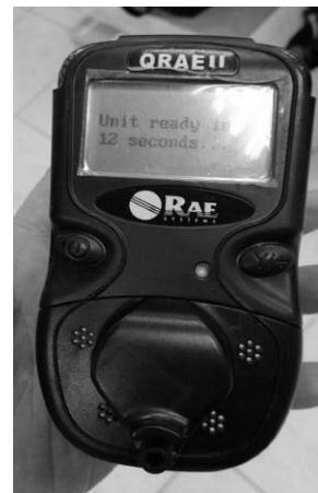
圖 3 進入箱涵勘查使用之四用氣體偵測器
