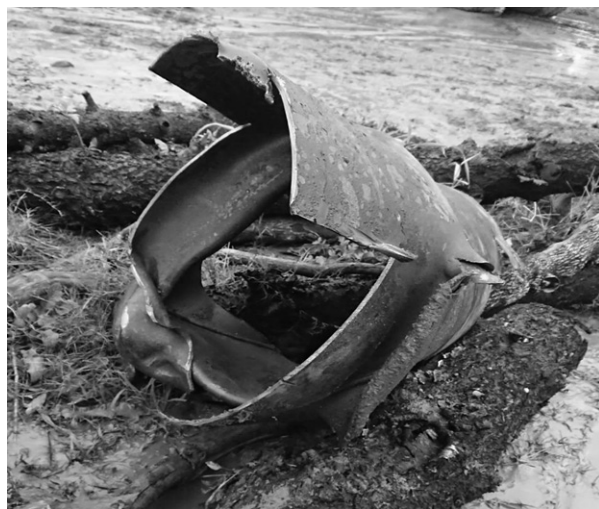
圖 1 新興路 500mm 鋼管扭曲變形
