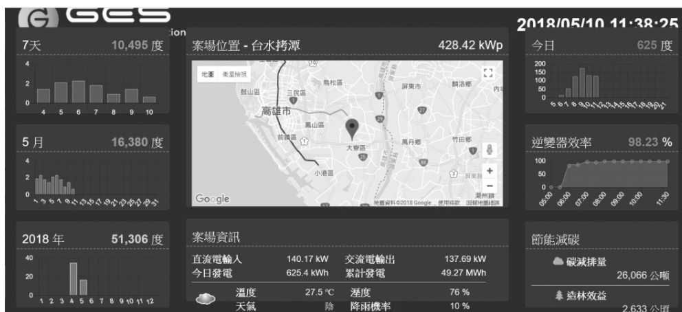
圖 3 拷潭淨水場太陽能發電資訊
