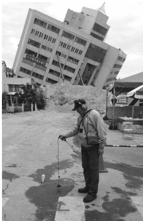
圖 3 台水公司第一、二階段共投入 70 位檢漏人員，全面性的積極檢漏。
