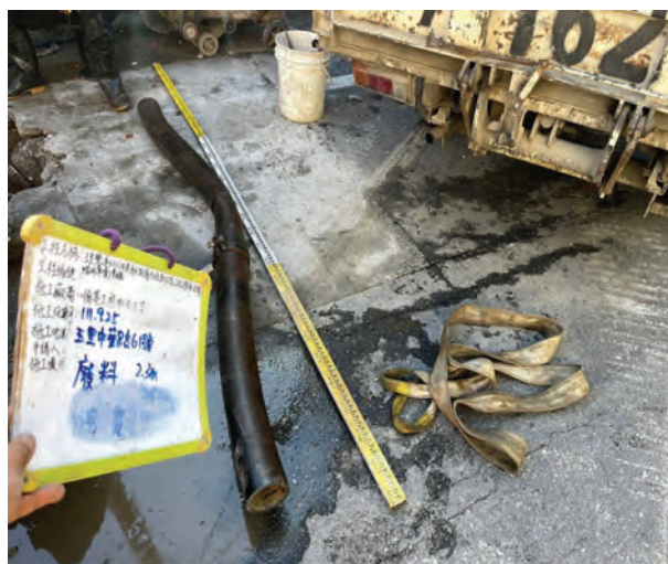
圖 14 玉里中華路 6 號 \phi 100-DIP 約 0.4M 垂直震幅
