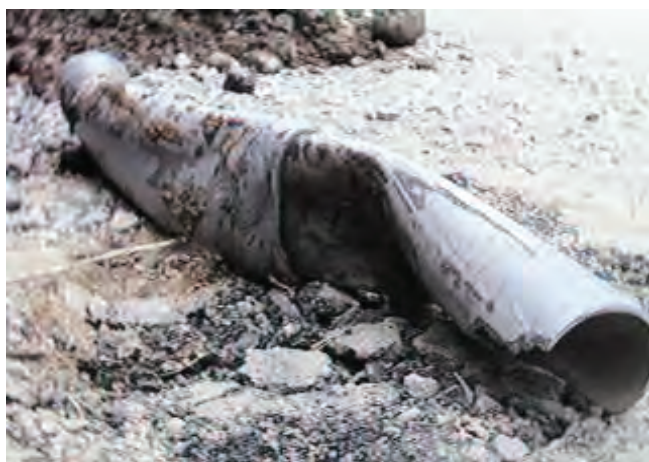
圖 3 卓蘭系統食水坑 \phi 150-PVCP 擠壓變形
