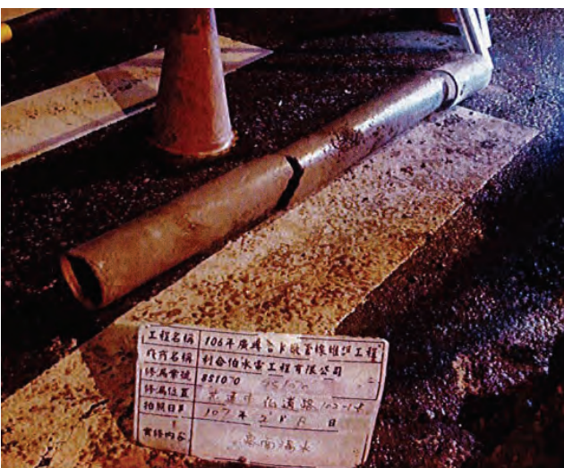
圖 8 花蓮市文化路 102-4 號 \phi 150 -PVCP 斷裂
