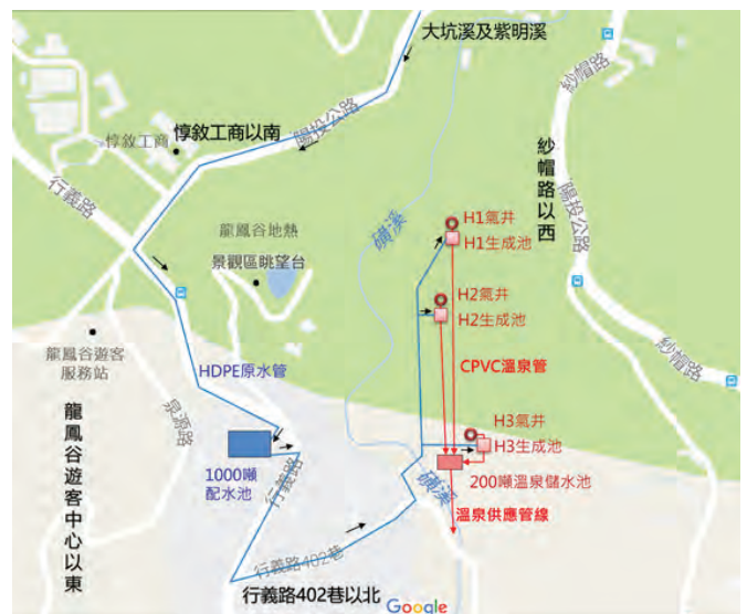
圖 2 行義路溫泉取供系統設施配置圖
