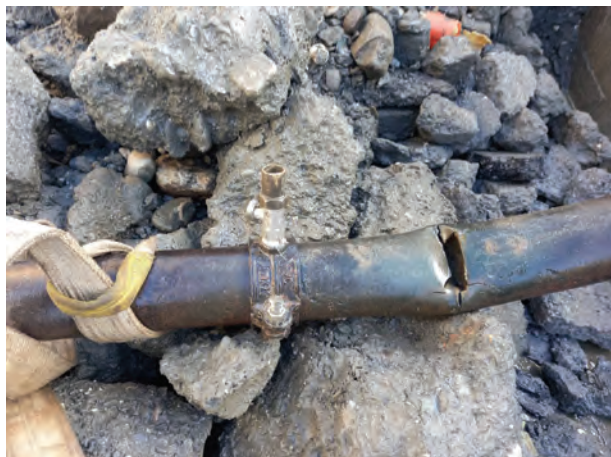
圖 15 玉里鎮中華路 6 號 \phi 100-DIP 垂直震幅折裂口約 8x2 公分
