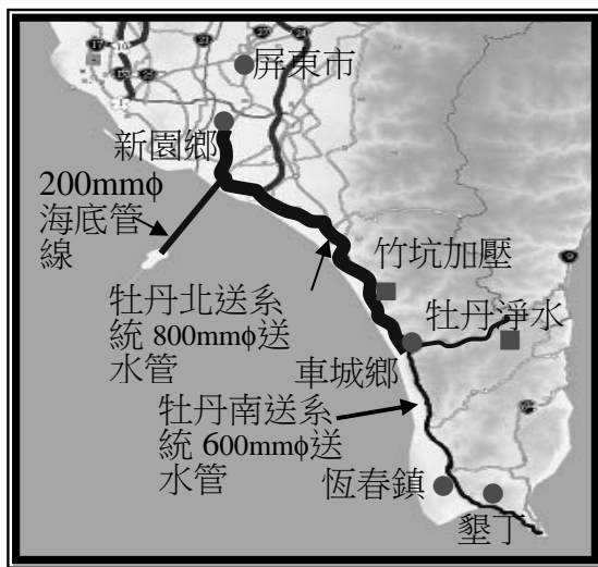
圖 3 牡丹系統送水管線平面圖
