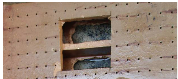
圖 8 呂寶式濾磚切開檢視照片
