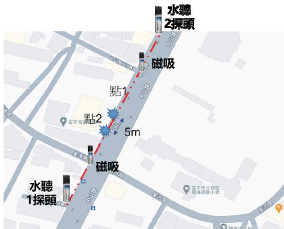
圖 12 檢出漏水點示意圖
