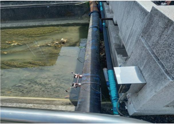
圖 5 中正橋巷口(200DIP)移動流量計量測
