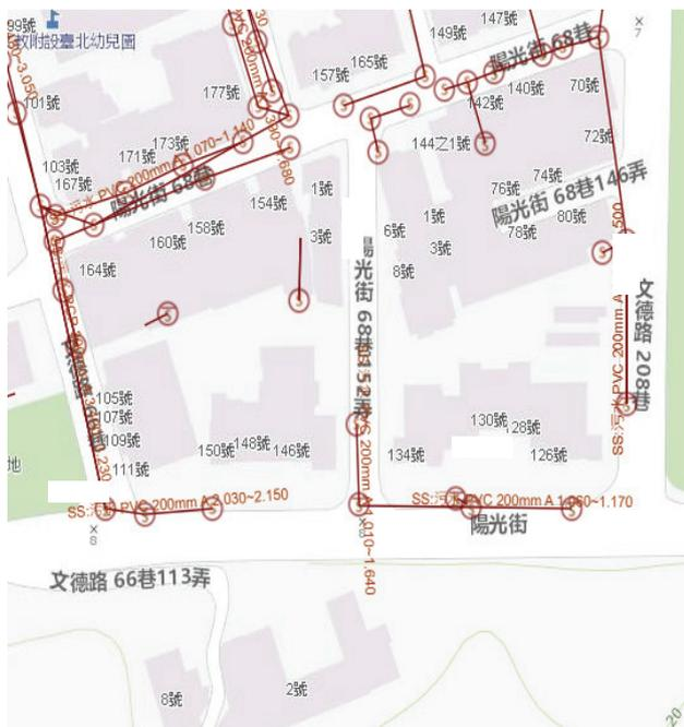
圖 11 臺北市道管中心衛工管圖資 2
