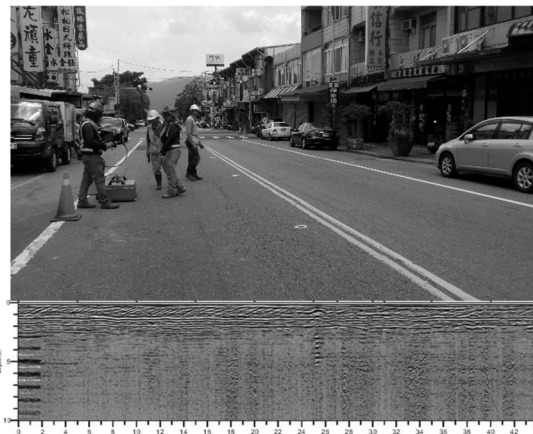
圖 16 透地雷達檢測過程及成果示意圖
