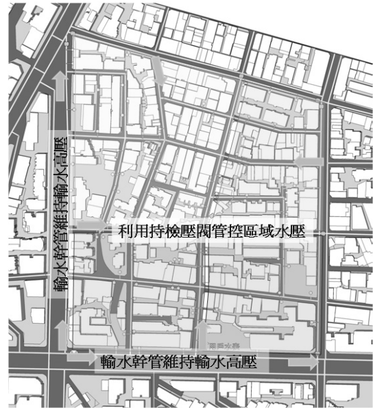
圖 17 設置持減壓閥均化各供水分區水壓
