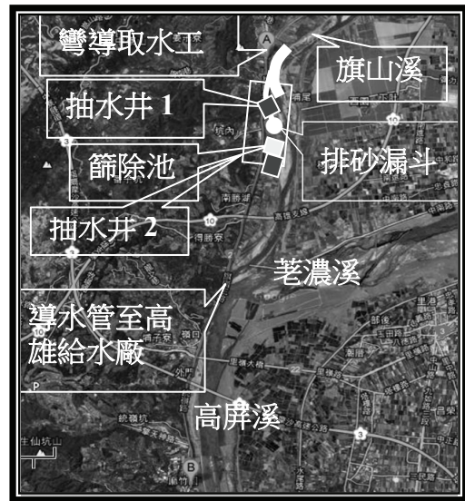
圖 9 彎道取水工等設施位置圖
