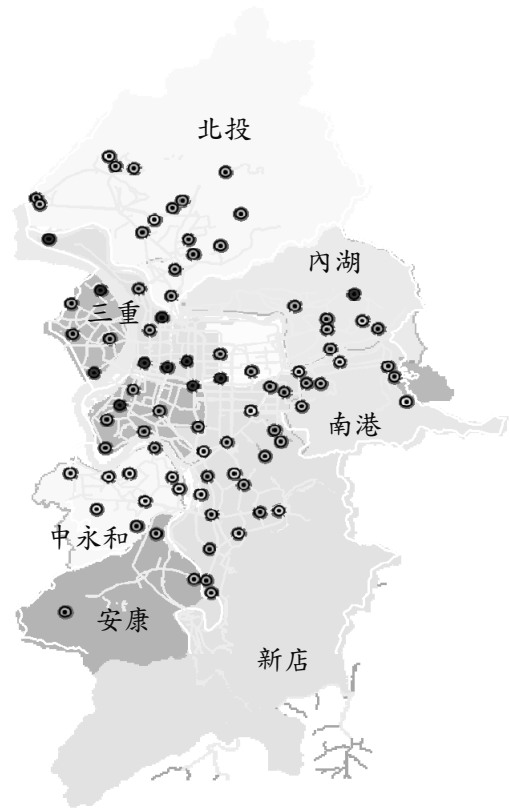
圖 8 北水處主要水壓監視點分佈圖
