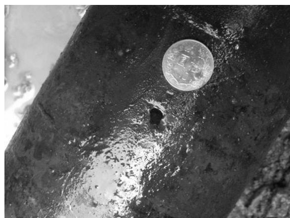
圖 13 \phi 150\text{mmDIP} 揚水管圓形孔洞
