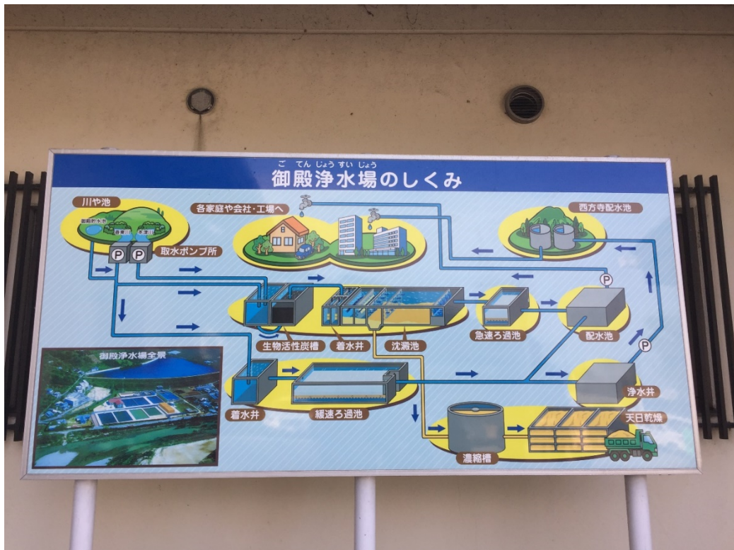
圖 12：御殿淨水場處理流程圖
